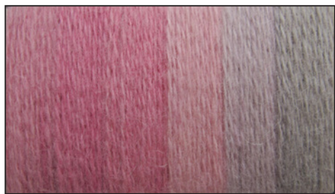
Standardní vybarvení vlněné příže kyselinou karmínovou z košenily. Odstíny zleva: vlna nemořená, mořená kamencem, mořená kamencem a chloridem cínatým, mořená kamencem a modrou skalicí, mořená kamencem a zelenou skalicí. Foto A. Samohýlová.
