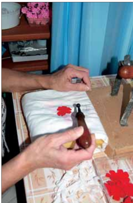
Kuflírování – tlak železek do plátku květu na molitanové podložce.
