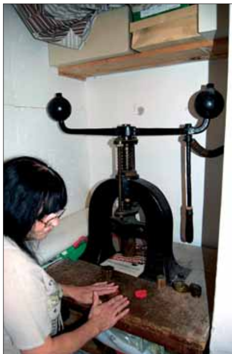
Příprava mosazných forem pro studené lisování.
