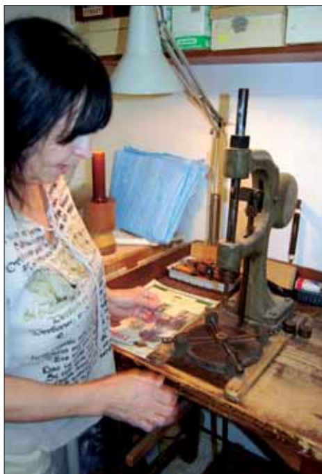
Tepelný lis – pres a vkládání kytek do kovové formy pod lis k vytvarování lístů pomněnky.
