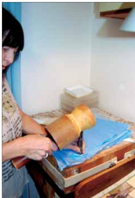
Vysekávání drobných kvítků na ponku pomocí raznice kyjem z pertinaxu.
